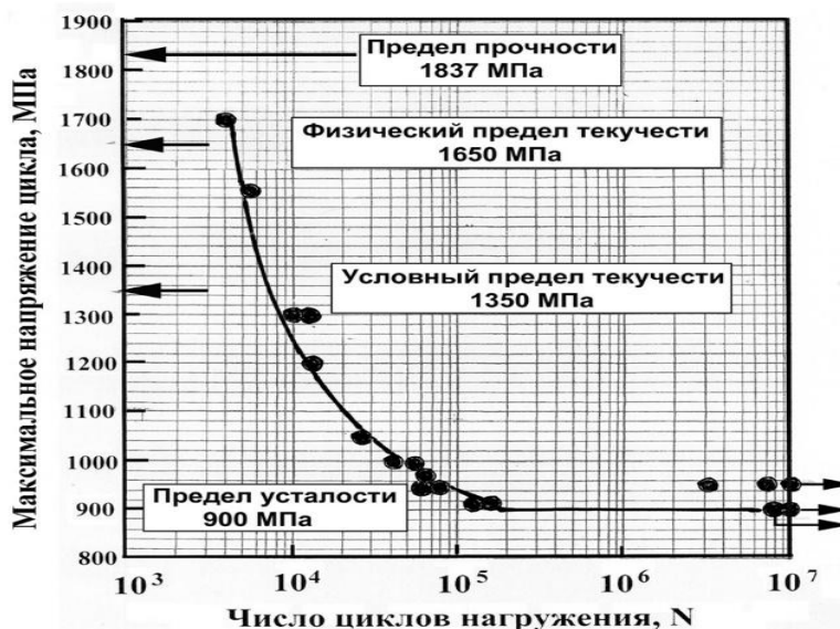
Рис. 5.2. Кривая усталости образцов из стали ВНС9-Ш
