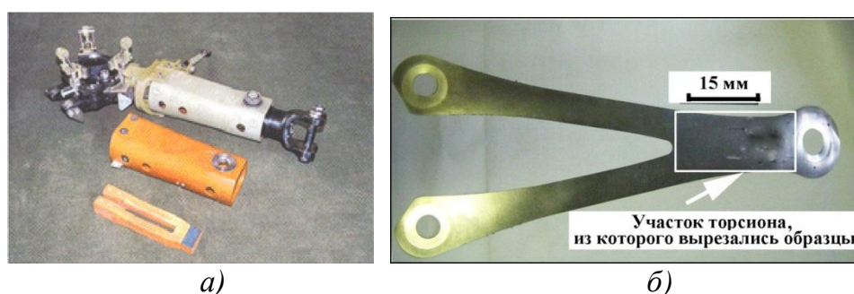
Рис. 5.21. Конструкция устройства [рукава] торсионного крепления лопасти вертолета к втулке несущего винта (а) [95] и зона вырезки материала, из торсионов после их эксплуатации (б).
