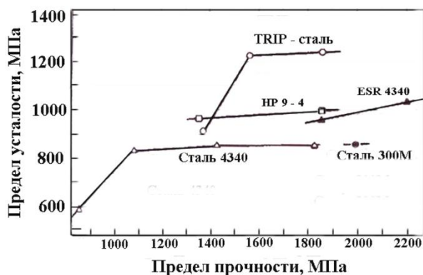
Рис. 1.6. Зависимость \sigma_R высокопрочных сталей от уровня предела прочности [20].
